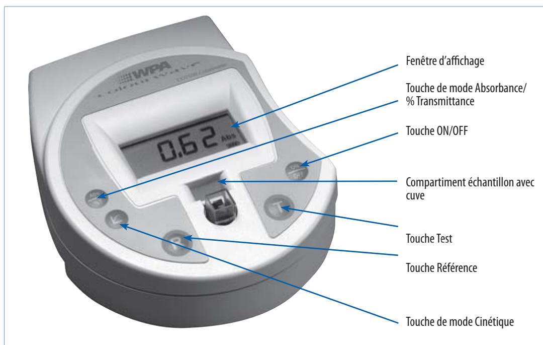
Figure 63. Commandes d'un colorimètre portable
