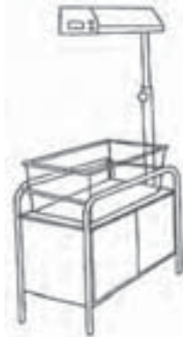
FIGURE S-1 Dispositif à chaleur radiante
